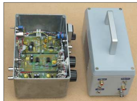
Bild 14: Der spezielle ELF/VLF-Verstärker links verfügt über einen Präzisionsgleichrichter und ist somit für Loggeraufzeichnungen verwendbar. Rechts ist eine abstimmbare Induktionsspule zu sehen.
