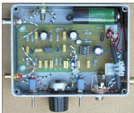
Bild 13: Innenaufbau des für die Messungen verwendeten Sfericsempfängers
