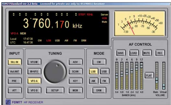
Bild 3: Auf der Bedienoberfläche sind Empfangsparameter per Maus und Tastatur zugänglich. Am rechten Rand liegt ein Equalizer zur Klangbeeinflussung. Fotos und Screenshots: DL1ABJ
