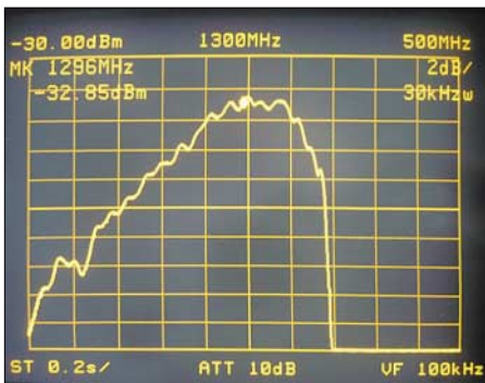
Bild 5: Wobbelkurve der 47-Element-Yagi, Gewinnmaximum bei 1299 MHz
