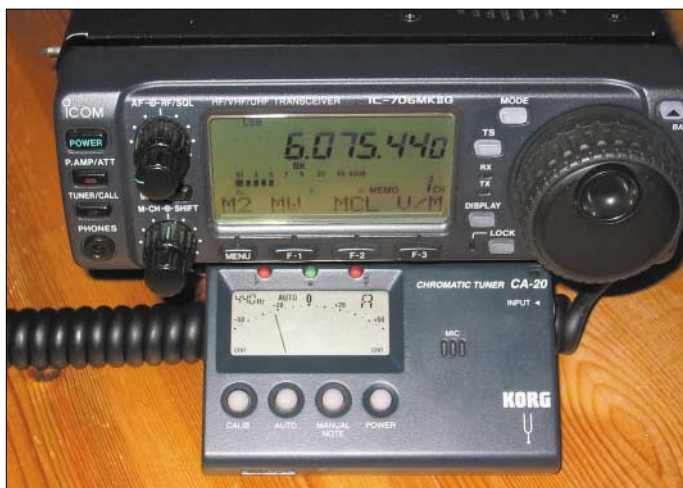
Bild 2: Differenzfrequenzmessung zwischen der Deutschen Welle als Referenzsender und dem Kammererton A
