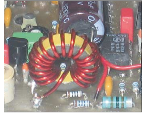
Bild 5: Schaltungsdetail Ringkernspule L3
