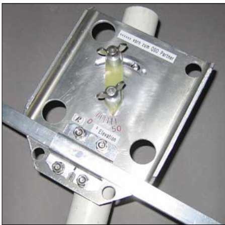
Bild 9: Eigenbau-Elevationsschelle für EME-Betrieb
