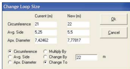
Bild 11: Im Fenster Change Loop Size , welches sich vom Draht -Menü aus unter Wire, Change Loop Size, Continue öffnen lässt, kann eine bereits definierte Schleife in ihrer Größe verändert und den Erfordernissen angepasst werden. Im hier gezeigten Untermenü ist festgelegt, dass der bisherige Umfang ( Current Circumference ) von 21 m auf 22 m verändert ( Change To ) werden soll.
