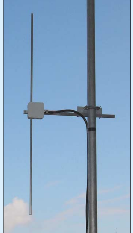
Bild 3: Fertiger Vormastdipol; alle Aussagen in diesem Beitrag beziehen sich auf vertikale Montage und Polarisation!
