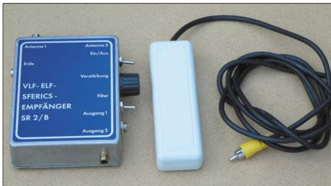
Bild 1: Die Kombination des Sfericeempfängers SR2/B und der Ferritantenne MASE 3 [4] erlaubt durch den Empfang der Sekundärfelder eine effiziente Längstwellenortung.
