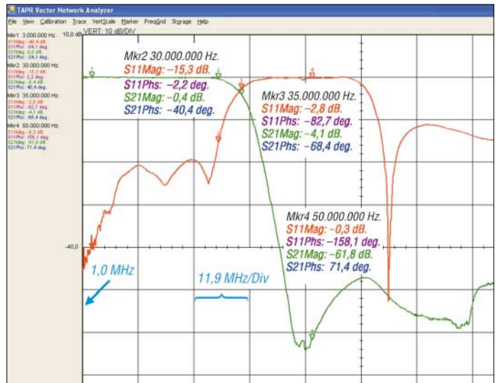
Bild 8: Messung an einem Tiefpassfilter für den KW-Bereich
